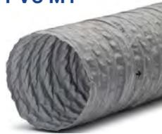
**Structure:** Gaine flexible très légère faite d'une paroi en tissu de verre enduit PVC classée au feu suivant la norme M1, renforcée d'une spirale en acier pour une mise à la terre.
