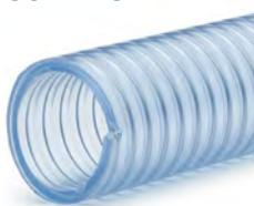
**Structure:** Tuyau flexible fait d'une paroi PVC très souple sans Phtalate de qualité alimentaire selon la norme 10/2011 modifiée (simulants A, B, C, D1) et CE 1935/2004, renforcé d'une spirale en PVC rigide transparent de qualité antichoc.
