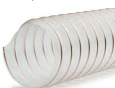
**Structure:** Gaine flexible faite d'une paroi de 0,4mm en polyuréthane polyéther souple de qualité alimentaire selon la norme 10/2011 modifiée (simulant E) et CE 1935/2004, renforcée d'une spirale en acier ressort cuivrée pour une mise à la terre. Sans halogènes et sans plastifiants. Résistant à l'hydrolyse et aux attaques microbiennes.
