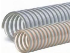
**Structure:** Gaine flexible faite d'une paroi polyuréthane polyéther souple de qualité alimentaire selon la norme 10/2011 modifiée et CE 1935/2004, renforcée d'une spirale en PVC rigide antichoc. Version ANT munie d'une spire de cuivre pour une mise à terre.
