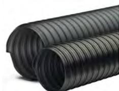
**Structure:** Gaine flexible faite d'une paroi polyuréthane polyester souple, renforcée d'une spirale en acier ressort cuivrée pour une mise à la terre. Très lisse intérieur. SERIE 5 PUR SX: Paroi 1,4mm. SERIE 5 PUR S2X: Paroi 2,0mm. SERIE 5 PUR S3X: Paroi 2,5mm.
