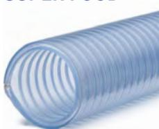
**Structure:** Tuyau flexible fait d'une paroi PVC souple sans phtalate de qualité alimentaire selon règlement EU 10/2011 modifié (simulants A, B, C, D1) et CE 1935/2004, renforcé d'une spirale en acier gainée PVC.
