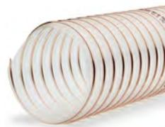
**Structure:** Gaine flexible faite d'une paroi polyuréthane polyéther antistatique R<10<sup>9</sup> Ohm/m souple, renforcée d'une spirale en acier ressort cuivrée pour une mise à la terre. Sans halogènes et sans plastifiants.
