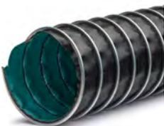
**Structure:** Gaine flexible légère faite d'une paroi en tissu polyester enduit d'Hypalon, renforcée d'un profil en acier galvanisé.
