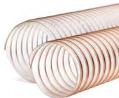
**Structure:** Gaine flexible faite d'une paroi polyuréthane polyéther souple, classée feu selon la norme DIN 4102 B 1 et antistatique permanent (R<10<sup>8</sup> Ohm) conforme TRGS 727 et Atex 2014/34/EU; renforcée d'une spirale en acier cuivrée.
