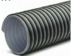
**Structure:** Tuyau flexible fait d'une paroi PVC extrêmement souple chargée Nitrile, renforcée d'une spirale en PVC rigide de qualité antichoc, en forme de "T" qui donne une flexibilité supérieure.
