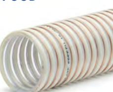
**Structure:** Tuyau flexible fait d'une paroi PVC souple de qualité alimentaire selon la norme 10/2011 modifiée (simulants A, B, C) et CE 1935/2004, renforcé d'une spirale en PVC rigide de qualité antichoc et d'une tresse de cuivre.
