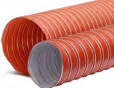
**Structure:** Gaine flexible légère faite d'une paroi en tissu de verre enduit de Silicône, renforcée d'une spirale acier. SIL 1: simple pli, SIL 2: double pli.
