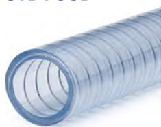
**Structure:** Tuyau flexible fait d'une paroi PVC souple sans phtalate de qualité alimentaire selon la norme 10/2011 modifiée (simulants A, B, C, D1) et CE 1935/2004, renforcé d'une spirale en acier galvanisé.
