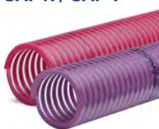
**Structure:** Tuyau flexible fait d'une paroi PVC souple sans Phtalate de qualité alimentaire selon la norme 10/2011 modifiée (simulants A, B, C, D1) et CE 1935/2004, renforcé d'une spirale en PVC rigide de qualité antichoc.
