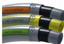
**Structure:** 4 couches PVC superposées avec une couche de renforcement "Steady Mesh" qui est une combinaison entre le tissage « guipé » et le tricot croisé, offrant les avantages de stabilité d'un tuyau guipé sous pression et la flexibilité d'un tuyau tricoté.
