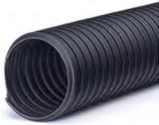
**Structure:** Gaine flexible légère faite d'une paroi en tissu de polyester enduit polyuréthane classée au feu suivant la norme M1, renforcée d'une spirale en acier pour une mise à la terre. Sans halogènes et sans plastifiants.
