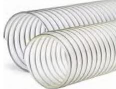
**Structure:** Gaine flexible faite d'une paroi polyuréthane polyéther souple de qualité alimentaire selon la norme CE 1935/2004 et la EU 10/2011 modifiée ainsi que la réglementation FDA-Norme 21 CFR 177.2600 et 178.2010 et antistatique permanent (R<10<sup>9</sup> Ohm), renforcée d'une spirale en inox. INOXX PU 04 FOOD: Paroi 0,4mm. INOXX PU 07 FOOD: Paroi 0,7mm. INOXX PU 14 FOOD: Paroi 1,4mm.
