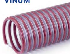
**Structure:** Tuyau flexible breveté sur le principe original d'une double spirale, comportant une spirale interne, utilisée comme support principal de la structure du tuyau, et une seconde spirale externe assurant une flexion sans pli et un renfort supplémentaire à la résistance du tuyau au vide.
