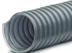
**Structure:** Gaine flexible de poids moyen, faite d'une paroi en PVC souple résistant au feu selon la norme UL94 V0 (en fonction de l'épaisseur de matière - nous consulter), renforcée d'une spirale en acier gainée PVC. Construction spéciale avec une paroi en « vague » pour une flexibilité optimale. Spirale d'acier de mise à la terre.
