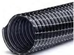
**Structure:** Gaine légère faite d'une paroi en PVC souple renforcée d'un quipage textile polyester et d'une spirale en acier gainée PVC. Spirale d'acier de mise à la terre. Grande résistance longitudinale à la traction.
