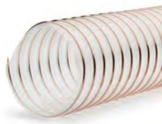
**Structure:** Gaine flexible faite d'une paroi polyuréthane polyester souple, renforcée d'une spirale en acier ressort cuivrée pour une mise à la terre. Sans halogènes et sans plastifiants. FLEXX PU 04 IND: Paroi 0,4mm, FLEXX PU 06 IND: Paroi 0,6mm.
