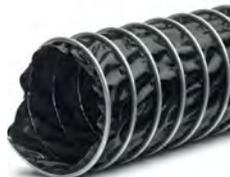
**Structure:** Gaine flexible très légère faite d'une paroi en tissu de verre enduit de Teflon électroconductive, renforcée d'un profil en acier galvanisé.
