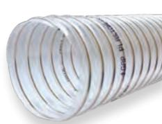
**Structure:** Gaine flexible faite d'une paroi polyuréthane polyéther souple de qualité alimentaire selon la norme 10/2011 modifiée (simulant E) et CE 1935/2004, renforcée d'une spirale en acier ressort cuivrée pour une mise à laterre. Sans halogènes et sans plastifiants.
