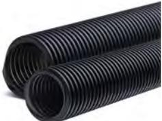
**Structure:** Gaine flexible faite d'une paroi en TPO souple convolutive. VSM 7418: Matière antistatique DIN 53482 R<10<sup>10</sup> Ohms. VSM 7440: Matière conductive DIN 53482 R<10<sup>6</sup> Ohms.
