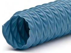
**Structure:** Gaine flexible légère, faite d'une paroi en PVC souple résistant au feu selon la norme M1, renforcée d'une spirale en acier. Spirale d'acier de mise à la terre.
