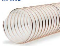
**Structure:** Gaine flexible faite d'une paroi polyuréthane polyester souple, renforcée d'une spirale en acier ressort cuivrée pour une mise à la terre. Sans halogènes et sans plastifiants.
