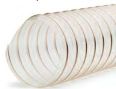
**Structure:** Gaine flexible faite d'une paroi polyuréthane polyéther antistatique R<10<sup>9</sup> Ohm/m souple, renforcée d'une spirale en acier ressort cuivrée pour une mise à la terre. Sans halogènes et sans plastifiants. Résistant à l'hydrolyse et aux attaques microbiennes.
