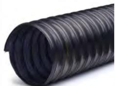
**Structure:** Gaine flexible légère faite d'une paroi en PE renforcée d'une spirale en acier. Version conductrice. Spirale d'acier de mise à la terre.
