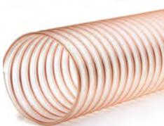
**Structure:** Gaine flexible faite d'une paroi polyuréthane polyéther souple de qualité alimentaire selon la norme 10/2011 modifiée et CE 1935/2004, renforcée d'une spirale en acier ressort cuivrée pour une mise à la terre. Surface intérieure très lisse. Sans halogènes et sans plastifiants.
