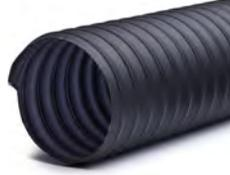
**Structure:** Gaine flexible légère faite d'une paroi en tissu de polyester enduit de TPE, renforcée d'une spirale acier.
