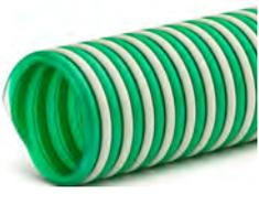
**Structure:** Tuyau flexible fait d'une paroi PVC très souple, résistant aux basses températures et aux UV, renforcée d'une spirale en PVC rigide de qualité antichoc.
